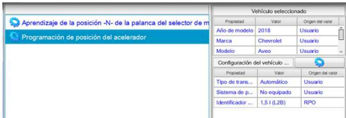
Programación de posición del acelerador. Esta función se realiza con equipo de diagnóstico y con ella el ECM reconoce la posición actual del estrangulador, ajustando las rpm reales.
